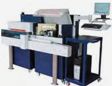
Foss CombiFoss公司的自动取样装置，展示牛乳样本的传输过程。
